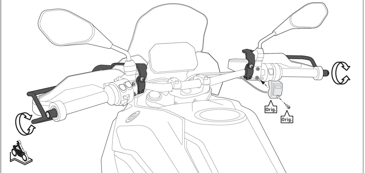
Allineare il paramani in modo che non entri in contatto con il parabrezza quando il volante è completamente girato.
