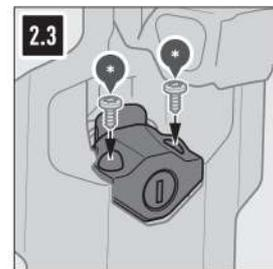
**Installazione della serratura del DUSC**
