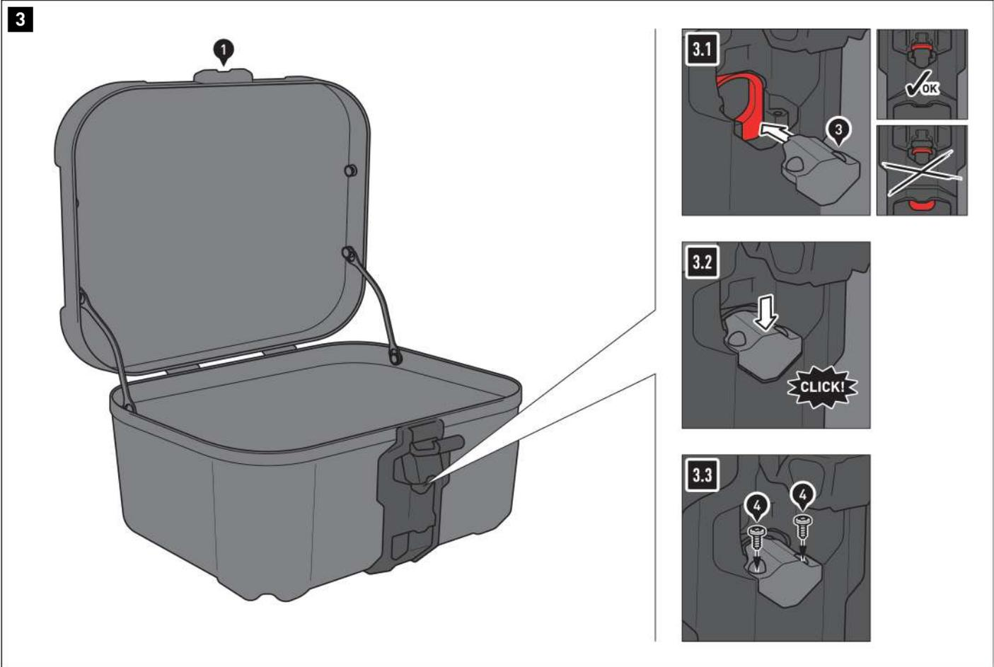
**Installare il connettore dell'alloggiamento della serratura**
