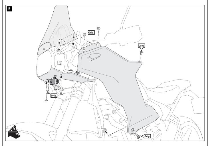
Riattaccare al veicolo le parti della carenatura precedentemente smontate. **A AVVERTENZA: Usare un frenafiletti liquido!**Avvitare le viti originali (Orig.) secondo le istruzioni del produttore.
