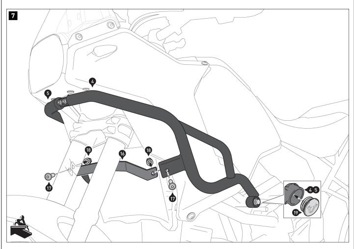
Avvitare ora la barra di congiunzione (16) alle metà della barra di protezione (4) e (5).
