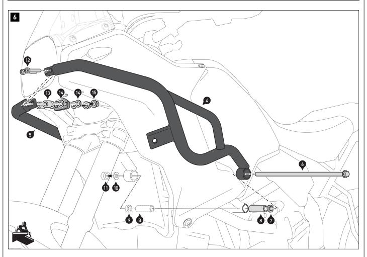
⚠AVVISO: se le barre di protezione vengono montate contemporaneamente alla protezione motore SW-MOTECH Motorschutz, non è necessario montare i distanziali (7) e (9).
