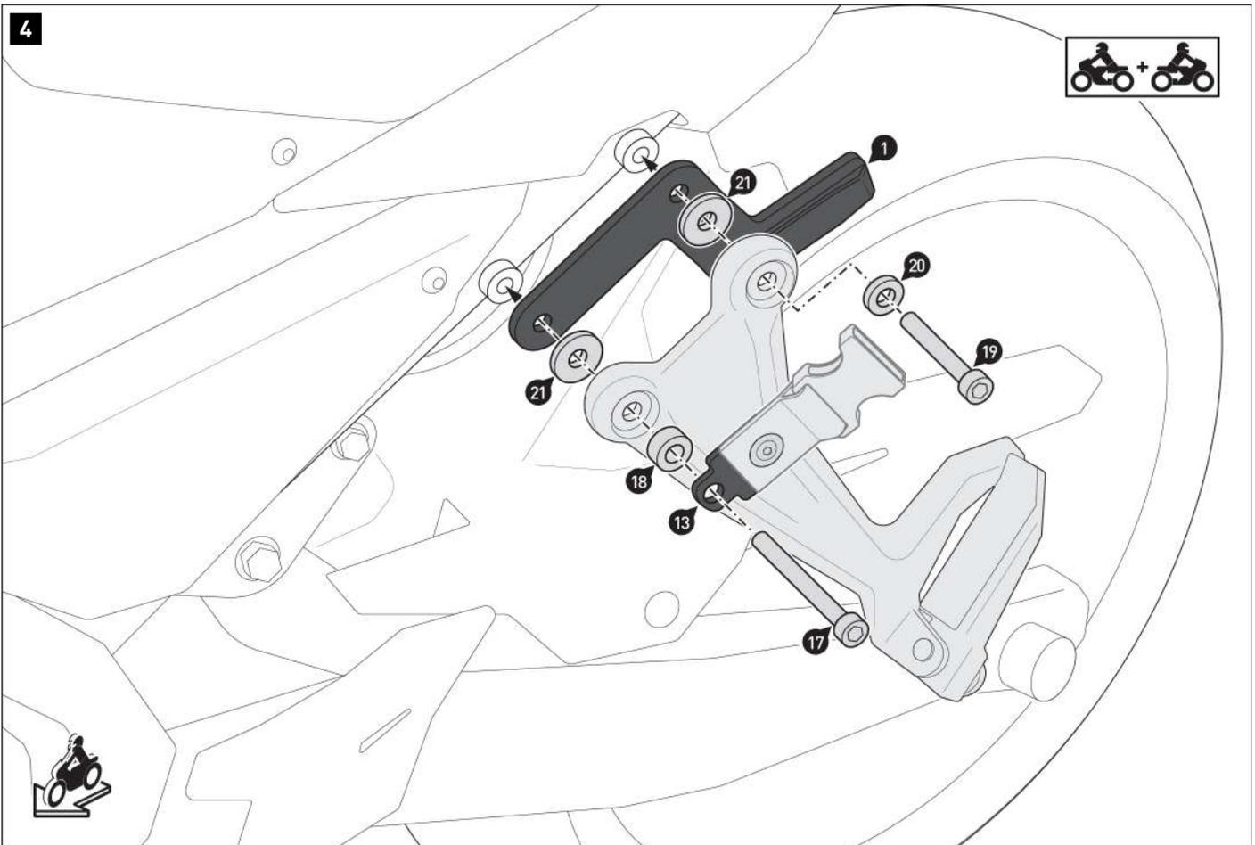
Avvitare le piastre di montaggio [1/2] e le piastre di montaggio [13] ai supporti della pedana passeggero del veicolo.
