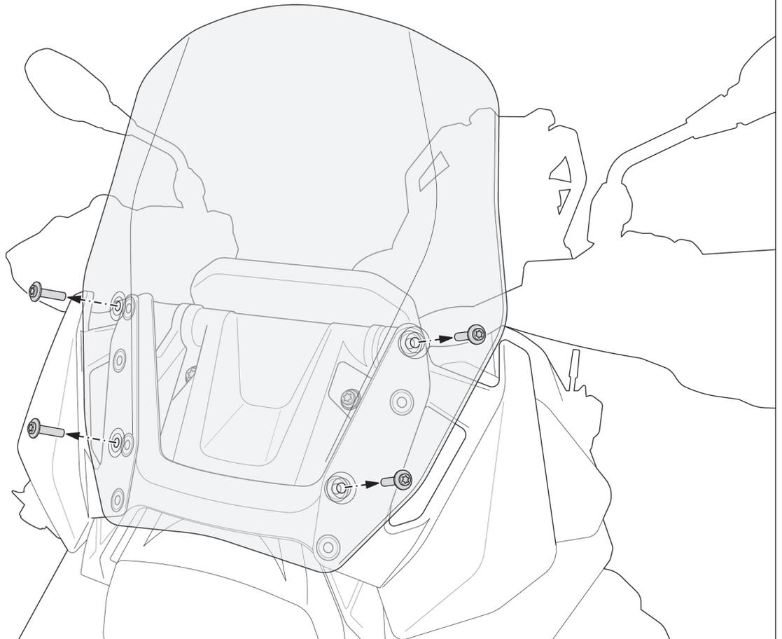
**⚠ AVVISIO:** i supporti del parabrezza sono inseriti privi di fissaggio, pertanto possono cadere una volta smontato il parabrezza.
