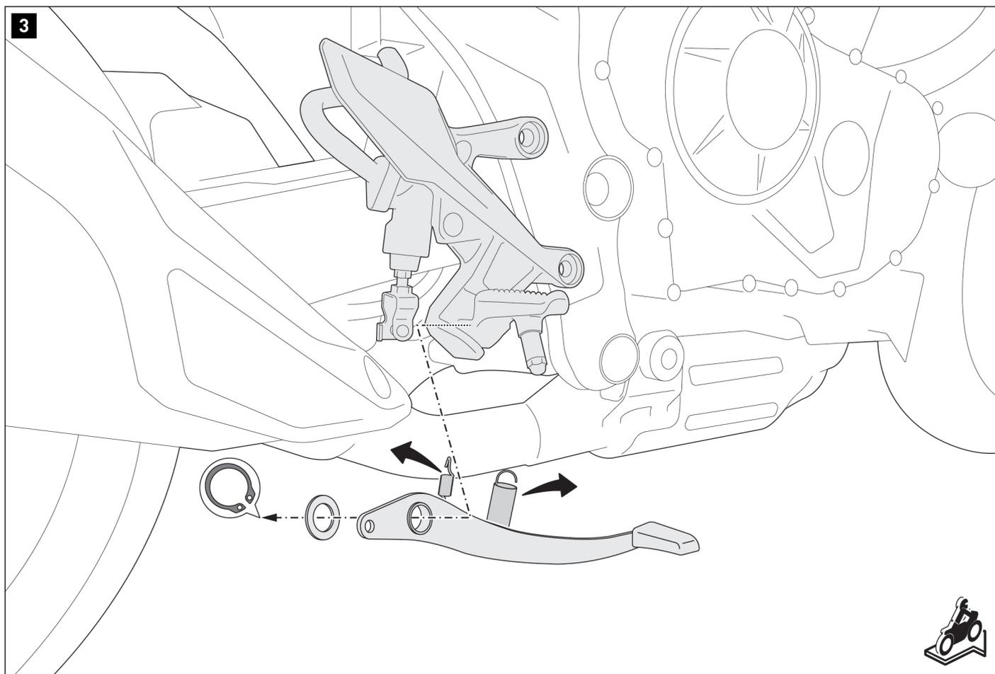
**⚠ AVVISO:** prima di smontare la leva del freno originale, annotare l'ordine e l'orientamento delle molle originali.
