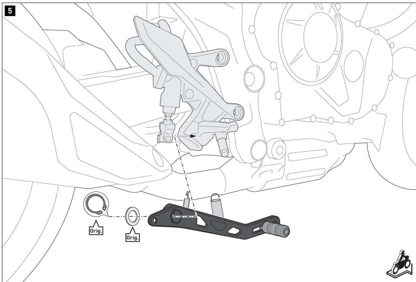
Montare la leva del freno a pedale (1) sul supporto della pedana utilizzando le parti originali (Orig.).
