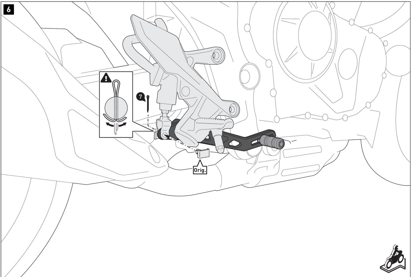
Montare l'asta di spinta del cilindro principale del freno (Orig.) con la relativa coppiglia [7].
